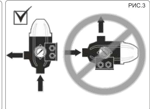
**Внимание:** Допускается только вертикальная установка реле. В любом другом положении оно не будет функционировать (рис.3).
